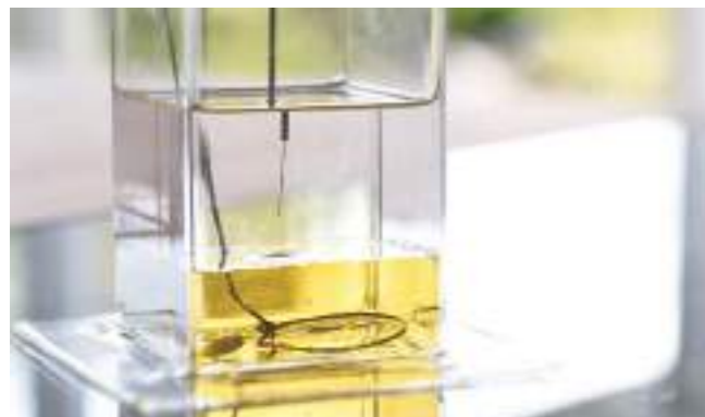
フェムトリアクター試作型装置/原料を噴霧・ミスト化し、界面で反応させナノ金属を合成する。
