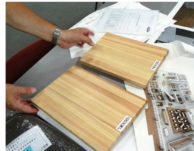
コーティングの条件をいくつか試して最適な状態を探す。
