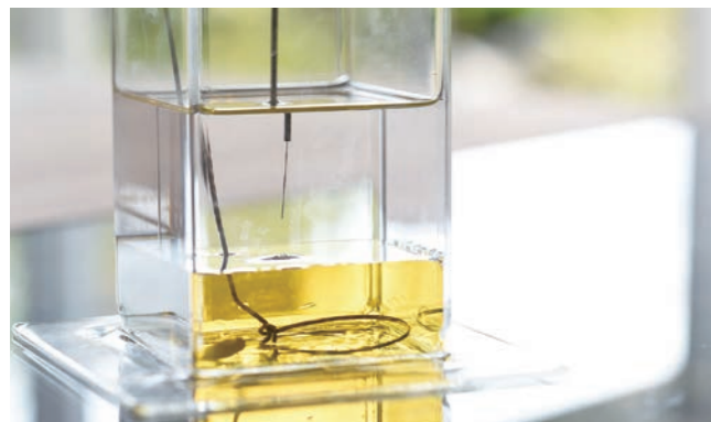
フェムトリアクター試作型装置/原料を噴霧・ミスト化し、界面で反応させナノ金属を合成する。
